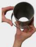
2. Installation de l'étrier sur l'embase
